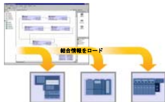
図10: 結合情報はコンフィグレーション後にフィールド・デバイスにダウンロードされる
